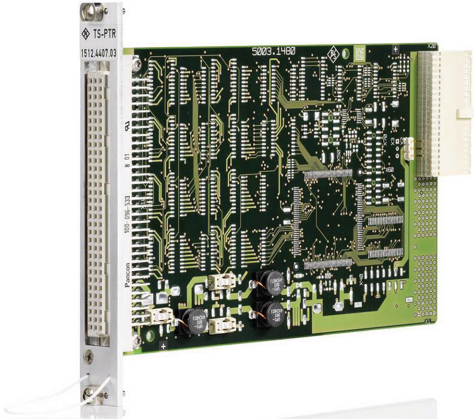
Bild 3-1 Ansicht des Moduls R&S TS-PTR
