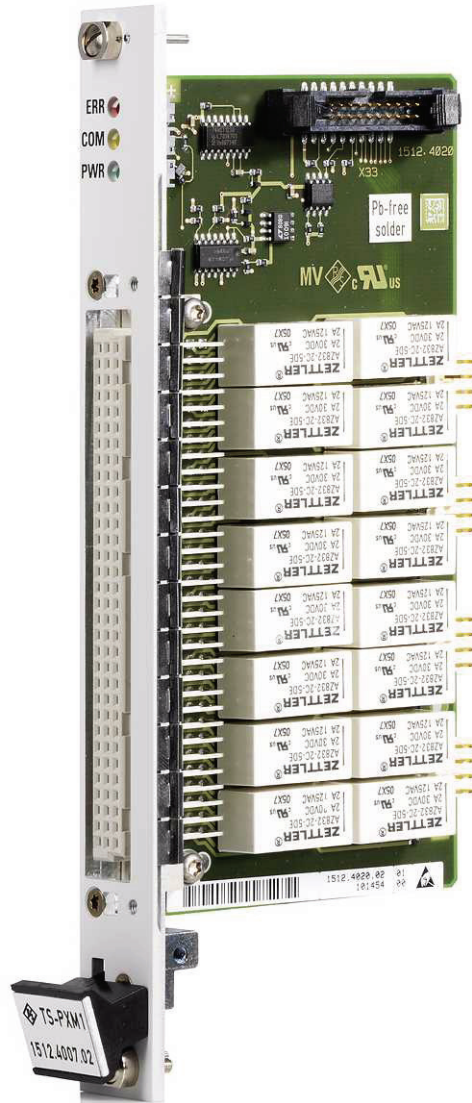
Bild 6-1 Ansicht des Moduls R&S TS-PXM1
